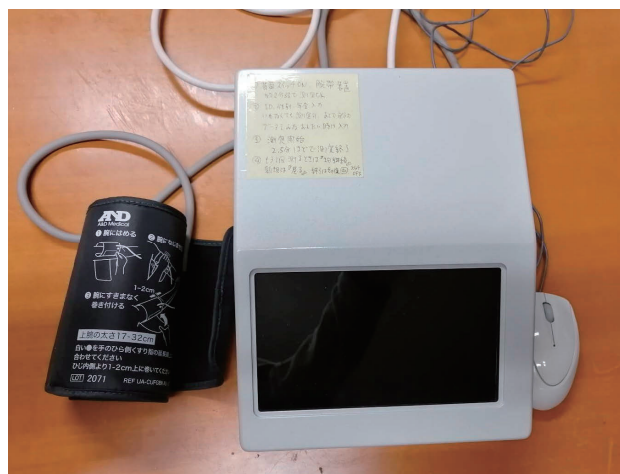
現在試作中の血圧計型動脈硬化度計測装置
