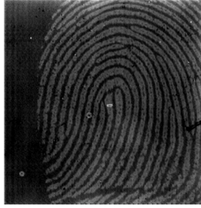
図 2. シート型イメージセンサーで撮像した指紋の画像
