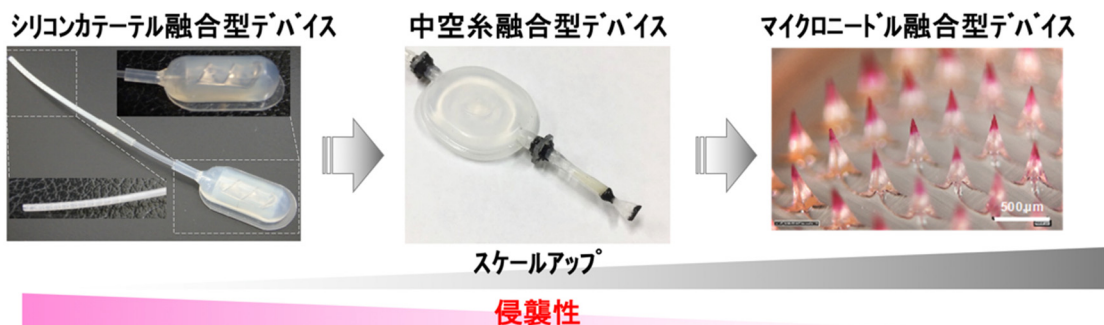
図 1. スケールアップと低侵襲性の両立を目指して：マイクロニードル融合型デバイスの考案 独自に開発したグルコース応答性ゲルとシリコンカテーテル、血液透析用中空糸、マイクロニードルなどを融合させ、種々の人工膵臓デバイスを作製し、スケールアップと低侵襲性の両立を図ってきた。
