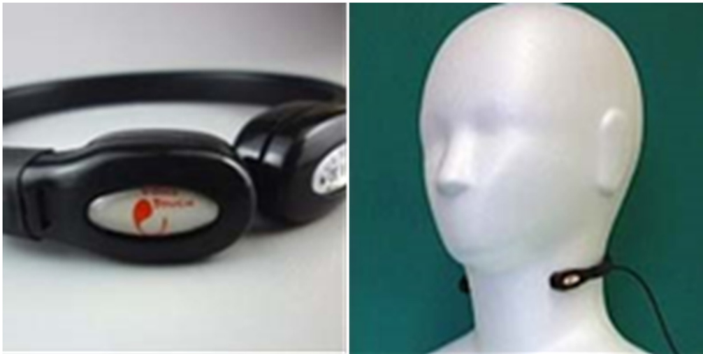
図1. 咽頭マイク／アンプ（SH-12jkl、NZ-680-A1、Nanzu electric Co.）
