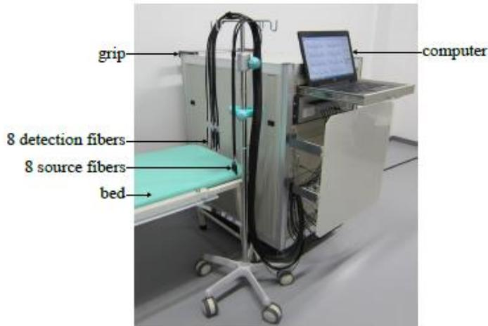
図1. タイムドメイン計測装置 (TRS-80)
