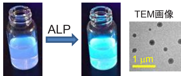
図 2. 作製した ALP 応答性液化色素ナノ粒子の蛍光応答および TEM 画像
