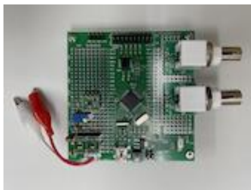
図3. 今回開発した小型・可搬型光源・検出システム
