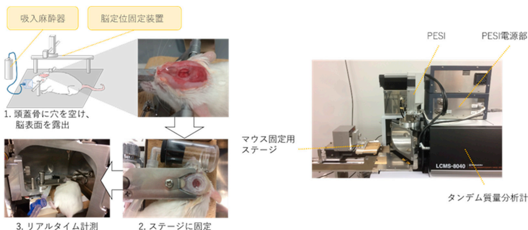
脳内メタボロームのリアルタイム分析のフローとシステム概略図
