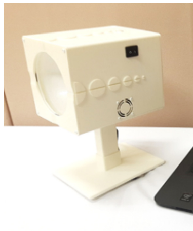
図3. 外装コーティングと排気口増設
