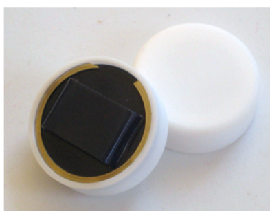
図 1. UV dosimeter badge 直径 3.6 cm、重さ 26 g
